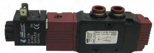
Corpo valvola con raccordo automatico su bocche 2 - 4. Connessioni 1-3-5 senza filetto. Body valve with Push-in fittings on ports 2 and 4. Connections 1-3-5 without thread.
